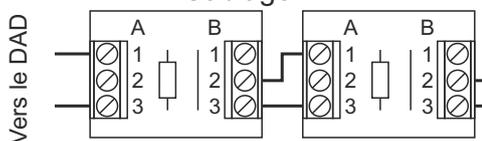
Raccordement électrique communs aux 3 modèles
